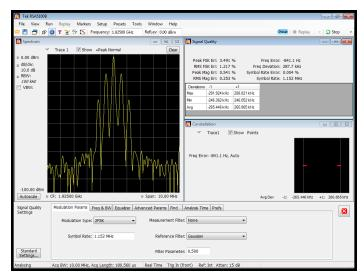
Option VM06 NADC, ( $\pi$ /4 DQPSK, 24.3 kS/s, 875 MHz, 0 dBm), RMS EVM: 0.3%
